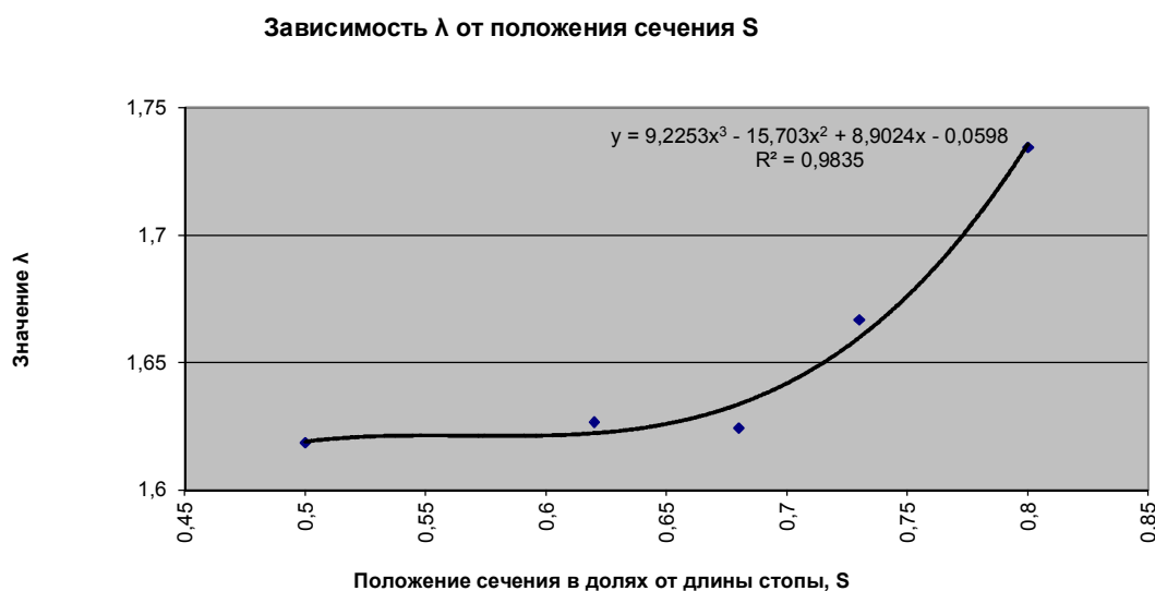
Рис. 2. Экспериментальная и теоретические зависимости характеристики сечения \lambda от положения сечения S (а – полиномиальная зависимость второй степени; б – полиномиальная зависимость третьей степени)
