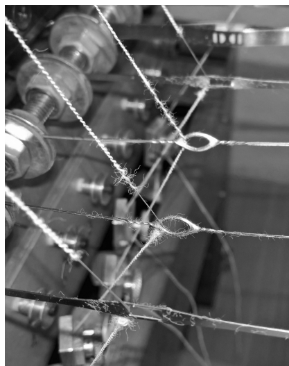
Рис. 2. Разрушение пряжи при истирании комбинированных нитей о различные типы галев
